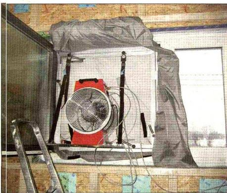
Bim Blower-Door-Test setzt ein in das Fenster eingebauter Ventilator das Haus unter Druck.
